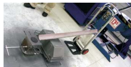
初期傾斜式流道澆鑄法配備
